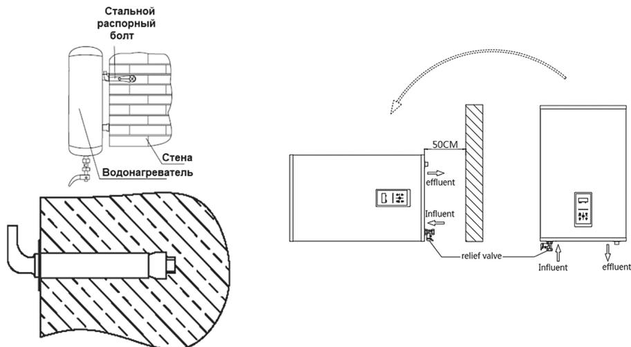
дополнительные меры для укрепления места монтажа водонагревателя.
