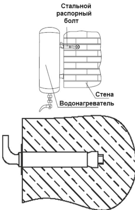
отверстия на одной и той же высоте глубина и диаметр которых зависят от технических характеристик конкретной модели водонагревателя и крепежа, поставляемого в комплекте. Расстояние между отверстиями должно быть 215 мм.
