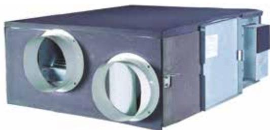
Приточно-вытяжные установки с рекуперацией тепла обеспечивают подачу наружного свежего воздуха и вытяжку воздуха из помещения. Это идеальное решение задачи вентиляции помещений как жилого, так и коммерческого типа. Блок рекуперации обеспечивает одновременный обмен скрытого и явного тепла, что позволяет регулировать температуру и влажность. Благодаря использованию пластинчатого рекуператора может быть сэкономлено до 70% энергии.
