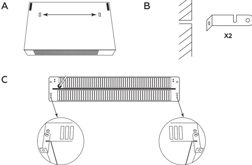
1. Измерьте расстояние между двумя пазами на задней поверхности прибора (см. рисунок 4 А).
