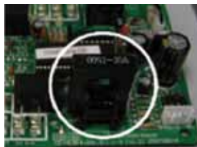
Защита компрессора по току
