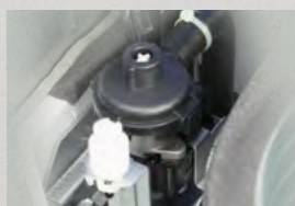
Новая помпа сниженный шум и вибрация
